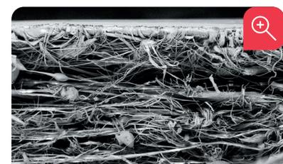
R.T.R.+ Membrane Querschnitt (stark vergrößert)
